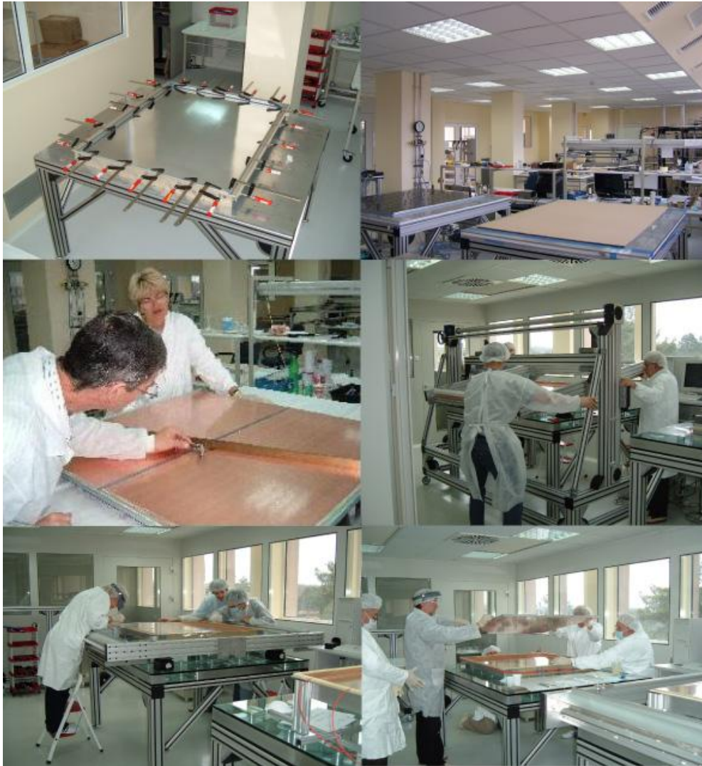
Fig. 9 Constructia in IFN-HH a detectorilor TRD pentru detectorul ALICE de la CERN: diferite etape de lucru
