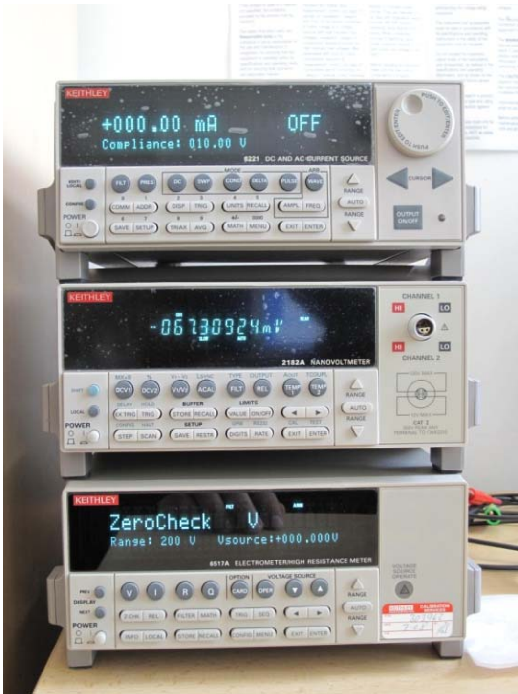
Fig. 8 Sistem Keithley pentru masurari de conductie electrica pe intervale mari de rezistente electrice.
