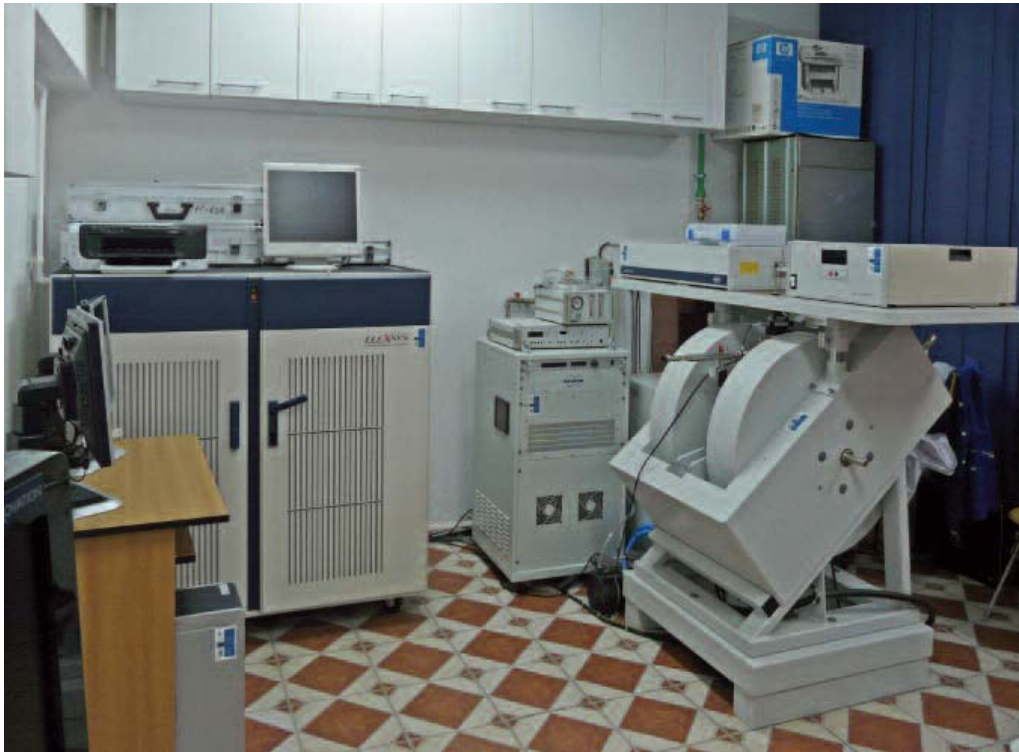
Fig. 4. Spectrometrul cu rezonanță electronică de spin (RES) în bandă X, cu transformată Fourier, model Bruker BioSpin ELEXSYS 580 10/12
