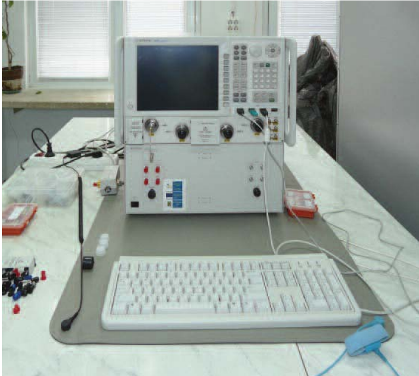
Fig. 5. Analizor de rețele vectoriale Agilent N5245A PNA-X kit de calibrare ghid de undă pentru fiecare bandă de frecvență a capetelor de unde milimetrice.
