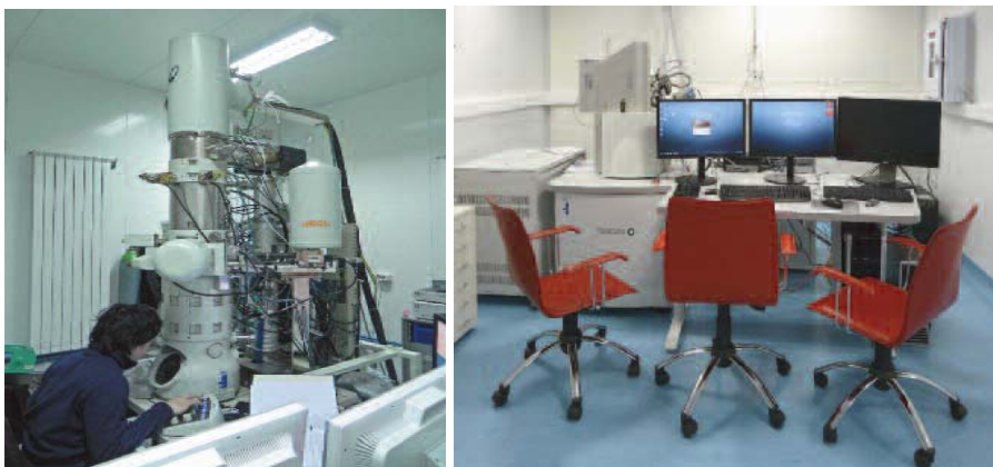
Fig. 1. Microscopul electronic JEM ARM 200 F; Sistemul dual SEM-FIB Tescan Lyra III XMU convergent (CBED); nanodifracție de electroni, STEM, EDS în mod spot, profil liniar sau cartografie 2D (rezoluție spațială 1 nm); EELS în regim de spectrometrie sau de imagistică filtrată în energie (spectrum image, EFTEM) cu rezoluție spațială la nivel atomic.
