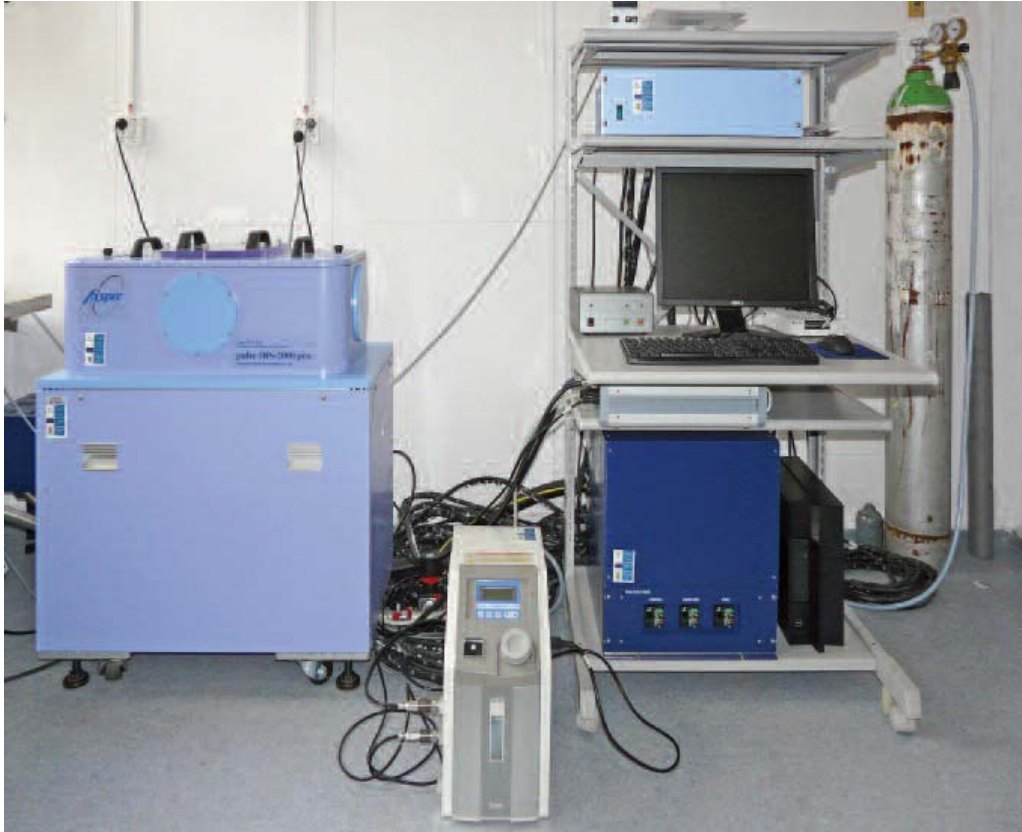
Fig. 6. Spectrometrul de microunde în banda de frecvență 40 GHz-7THz, Aispec pulse IRS2000
