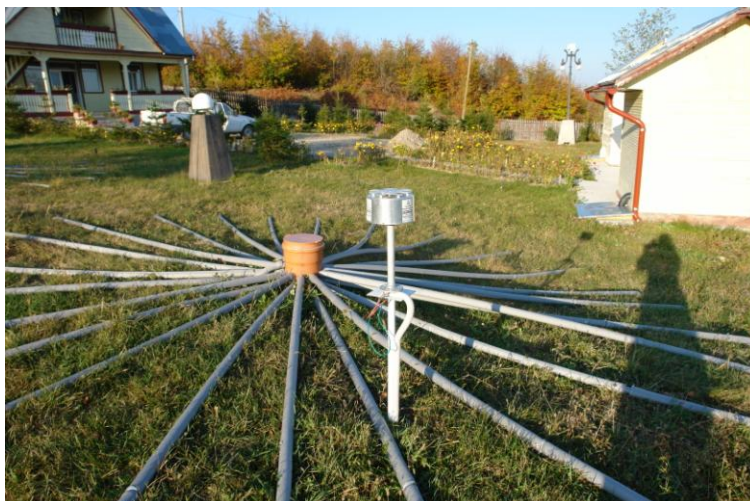
Figura 4. Senzorul de infrasunete Chaparal instalat la clădirea principală de la Observatorul Ploștina (în zona Vrancea)
