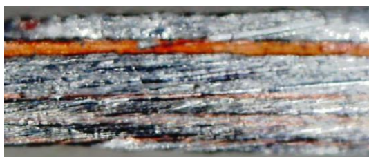
Figura 4.4. Stivă de două benzi lipite peste alte două benzi (al doilea caz de investigație);
